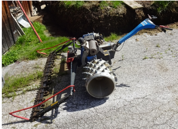
Abbildung 20: Mähmaschine, die auf den Einsatz im steilen Gelände spezialisiert ist. (Eigene Aufnahme, 06.08.2021)
